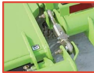
Smarowane wytrzymałe śruby rzymskie do poziomowania maszyny
