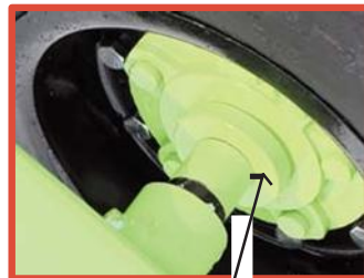
Metalowe osłony uszczelnień łożysk na piastach 517
